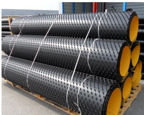
Figure 18. Rouleaux en PEHD 3 mm coextrudé
